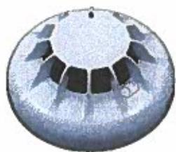
Este un detector optic de fum adresabil, LED semnalizare stare, compatibil cu centrale, umiditate relativă 95% fără condensare, temperatură de funcționare: -20 ... +70°C.
