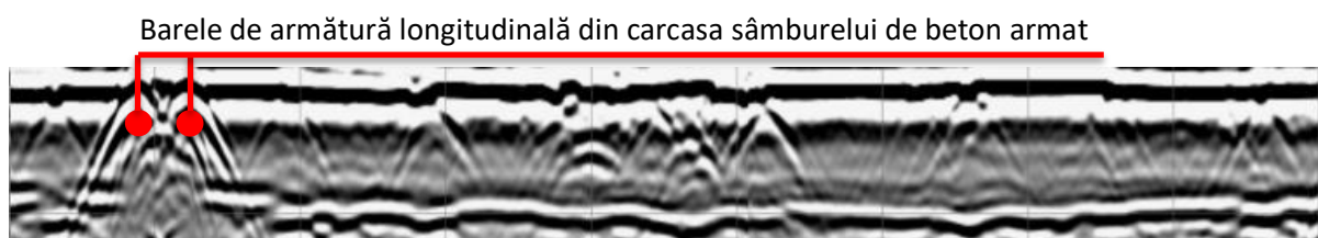
Fig. 10 – Scanare realizată pe frontonul din axul 9 în vederea interceptării armăturii longitudinale din carcasa sâmburilor de beton armat
