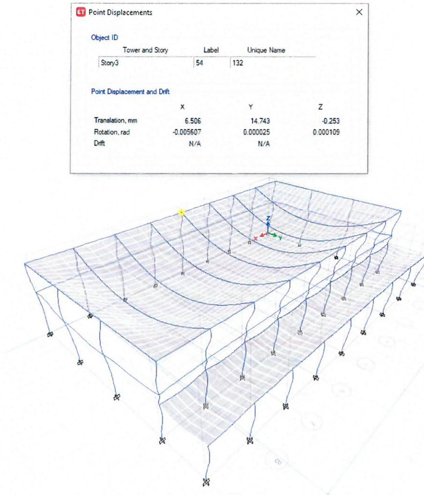
Fig. 6 - Deformația maximă pe direcție transversală - Grupare Seismică
