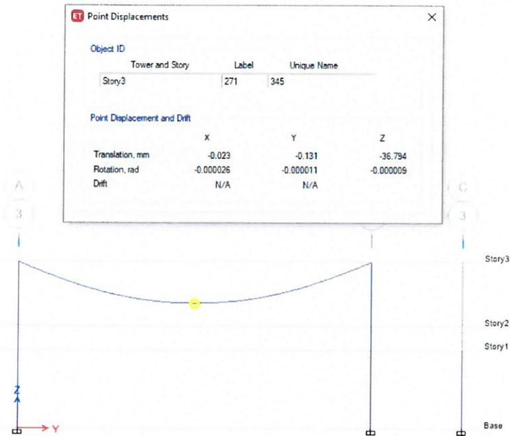
Fig. 7 - Deformația grinzii principale în SLS - Grupare Fundamentală
